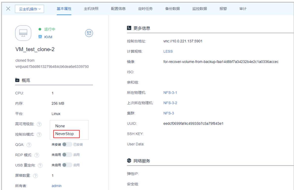
开启高可用模式后，KVM代理对共享目录定期写入，并把检测信息通知给管理服务，以提供高可用切换机制判断依据。如图 23: [ZStack高可用机制-共享存储心跳检测](#)所示：
